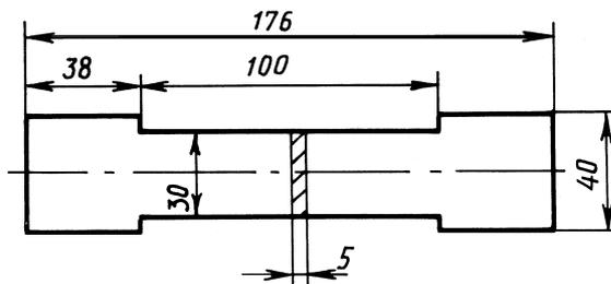
2. Заготовку рихтуют и шлифуют на глубину  $0,2-0,3$  мм. Параметр шероховатости поверхности  $Ra \leq 1,6$  мкм по ГОСТ 2789.
